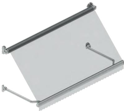
Konstrukci markýzy tvoří válec pro navíjení potahu, výklopná ramena s pružinami, výpadový profil a ovládací mechanismus. Ramena je možné vyklopit do 170°. Markýzu je možné monitovat čelně na fasádu nebo do ostění.
